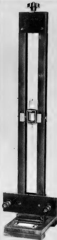
Bild 4. Ansicht des Spiegelgalvanoskops
